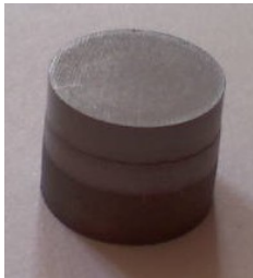
Figure 71 : Exemple d'échantillon cohésif (et tronconique) après frittage
