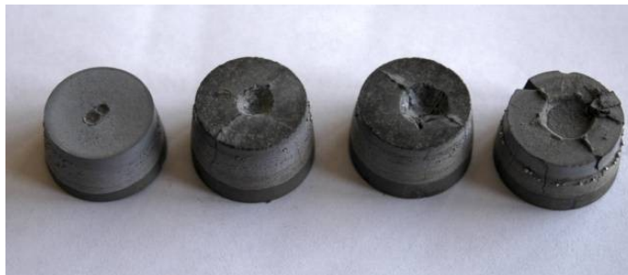
Endommagement de composites architecturés par perçage après un nombre croissant d'impacts appliqués (respectivement aucun, un, deux, et trois)
