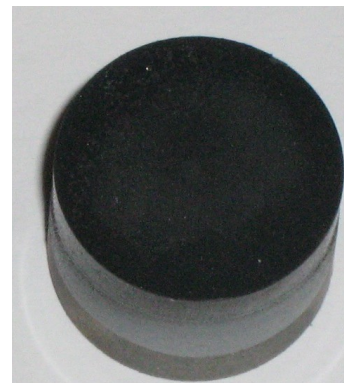
Figure 34 : Résidus de carbone (cycle interrompu à 1300°C)
