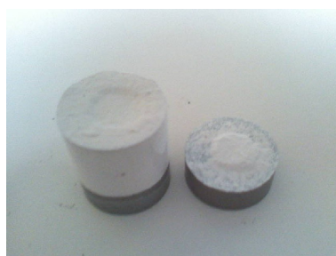
Figure 67 : Exemple de délamination à vert
