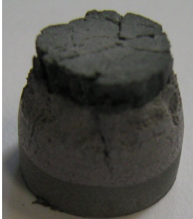
Propagation des fissures et ruine de la couronne extérieure (5 impacts)
