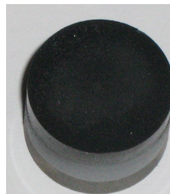
Figure 34 : Résidus de carbone (cycle interrompu à 1300°C)
