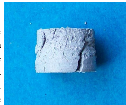
Figure 48 : Localisation de la déformation (compression uniaxiale - 50% 316L + 50% alumine)
