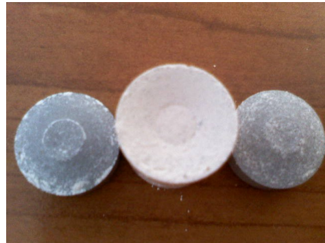
Figure 65 : Exemple de délaminations observées après déliantage
