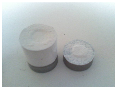
Figure 67 : Exemple de délamination à vert
