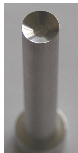
Figure 64 : Exemple de poinçon concave utilisé pour mettre en forme les interfaces entre couches
