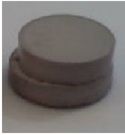
Figure 70 : Décobésion et frittage indépendant sur un échantillon multicouches
