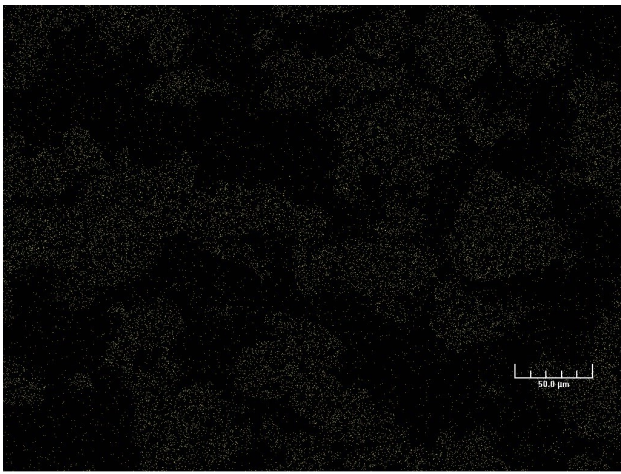
50% 316L – 50% alumine; déliantage Air; Frittage 1410°C; cartographie EDS du chrome
