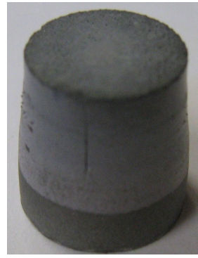
Première fissure (1 impact)
