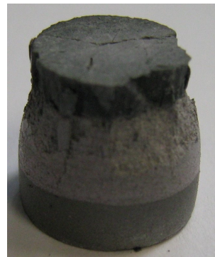
Propagation des fissures et ruine de la couronne extérieure (4 impacts)
