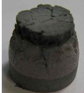
Propagation des fissures et ruine de la couronne extérieure (5 impacts)
