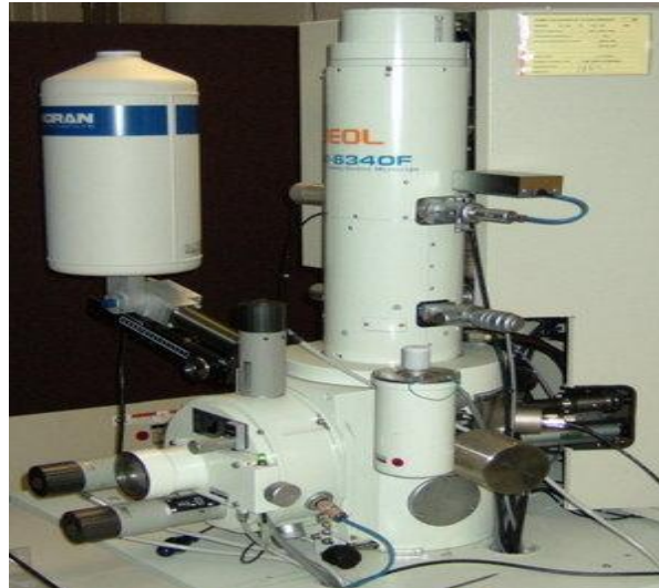
Figure II.10 : Appareil de microscopie à balayage électronique MEB.
