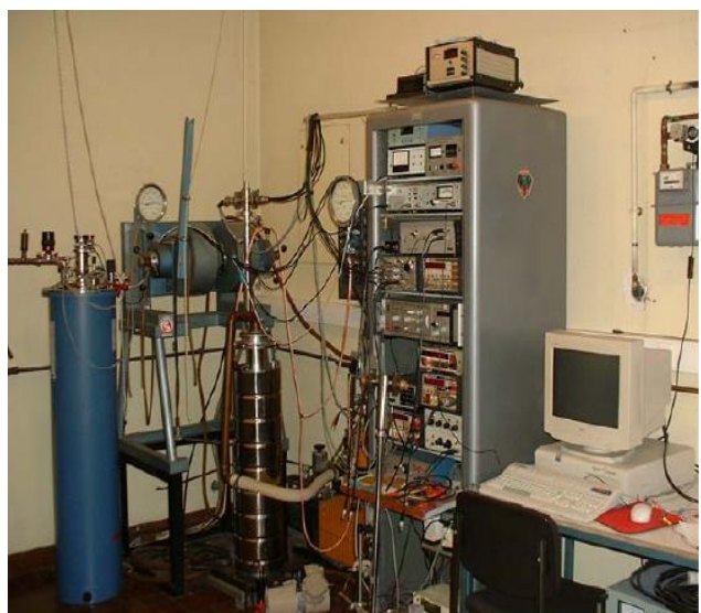
Figure II.13 : Dispositif de mesure de résistivité.
