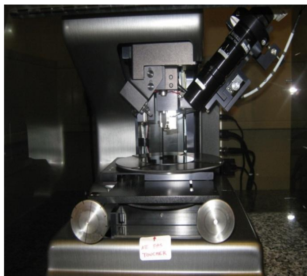
Figure II.11 : Profilomètre mécanique Dektak 32.
