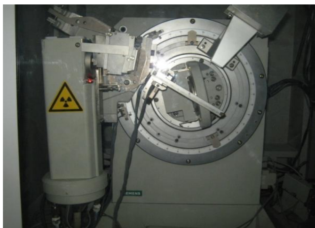
Figure II.5 : Diffractomètre RX Siemens D5000 en transmission ( \lambda_{K\alpha} Cu).
