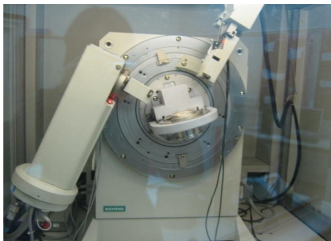
Figure II.4 : Diffractomètre RX Siemens D5000 en réflexion ( \lambda_{K\alpha} .Co).
