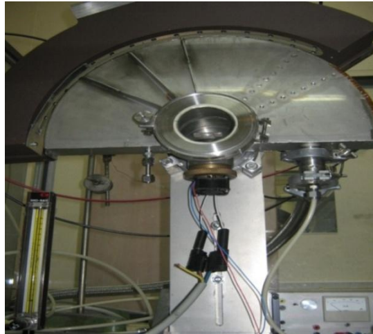
Figure II.6 : Diffractomètre à rayons X multicanaux INEL équipé d'un four haute température ( \lambda_{K\alpha} Cu).
