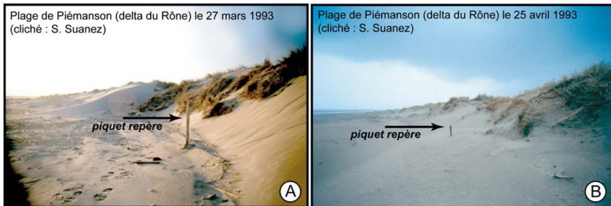
Photo 1. Changements morphosédimentaires des dunes de la plage de Piémanson (delta du Rhône). A : décapage du pied de dune et du haut de plage après un épisode de fort vent de terre. B : engraissement du pied de dune et du haut de plage après un épisode de fort vent de mer
