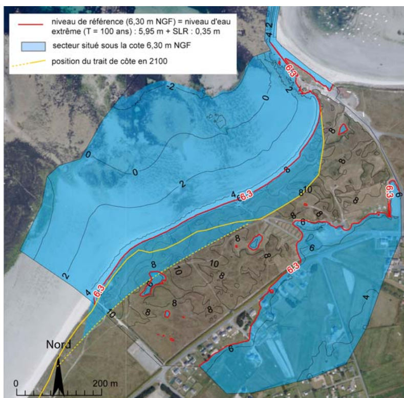
Figure 122. Cartographie prospective des zones inondables du secteur du Vougot – Curnic en tenant compte de l'élévation du niveau marin et de l'érosion du trait de côte pour 2100
