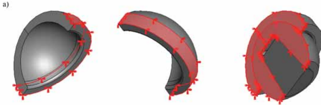
Figure IV.5 : Conditions aux limites appliquées au modèle. a) Condition d'encastrement de la cupule. Cette dernière est encastree au niveau de sa périphérie, chaque ergot symbolise le blocage du mouvement en translation dans la direction considérée. b) Condition de symétrie par rapport au plan vertical.
