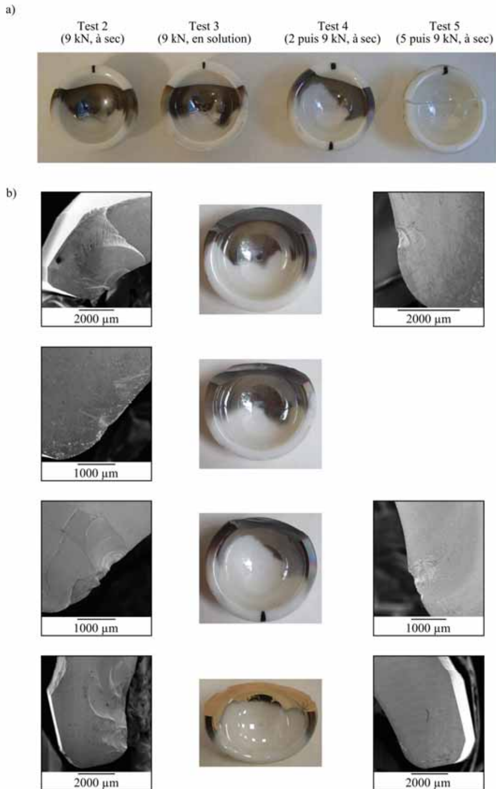
Figure III.16 : Observations des cupules en zircone rompues et des sites probables d'amorçage des ruptures au MEB. a) Photos des cupules après rupture, la coloration noire vient de la métallisation nécessaire avant le passage au MEB. b) Observations des zones probables d'amorçage des ruptures, pour chacune des cupules précédentes.
