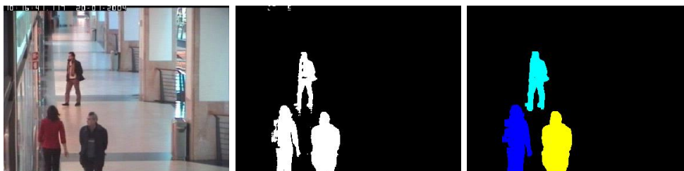
FIGURE 3.5: De gauche à droite : image originale, résultat de la soustraction de l'arrière-plan et résultat obtenu après post-traitement (une couleur représente une composante connectée).
