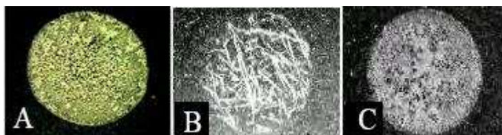
Figure 1.7. Cristallisation des matrices 24 : a) Acide \alpha -cyano-4-hydroxycinnamique (HCCA), b) Acide 2,5-dihydroxybenzoïque (DHB), c) Acide Sinapinique (SA).
