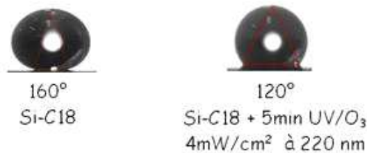
Figure 3.2. Angle de contact des nanofils de silicium fonctionnalisés par l'OTS avant (gauche) et après exposition à l'UV/ozone (droite).
