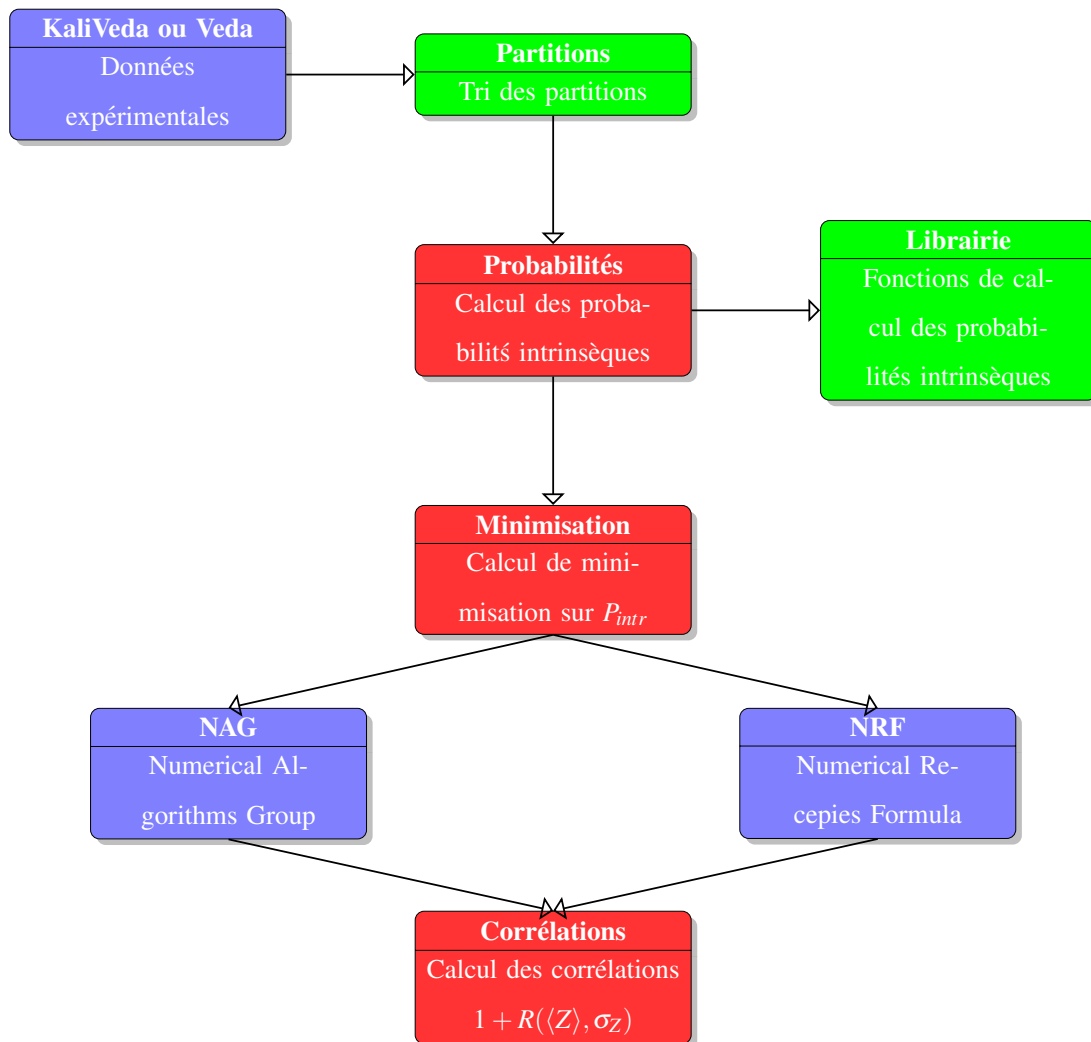
FIGURE 4.4 – Diagramme illustrant les différents programmes et logiciels utilisés dans le cadre du calcul des probabilités intrinsèques et des corrélations en charge. La couleur bleue est utilisée pour les parties provenant d'un code externe non-accessible (KaliVeda [Fra], NAG [nag], Numerical Recipes [HP88]). La couleur verte est le code programmé par P. Désesquelles et la couleur rouge est utilisée pour le code programmé par l'auteur.
