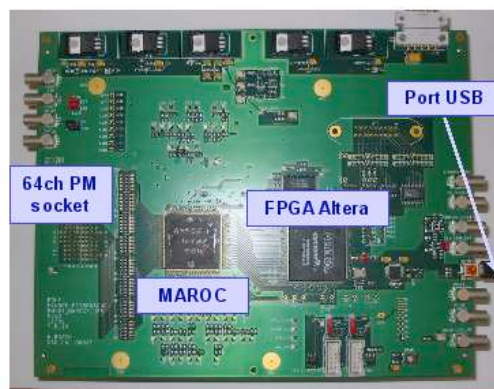
FIGURE 5.6: Carte de test avec la puce MAROC2 encapsulée et soudée. Un port USB permet la programmation et la commande du FPGA ALTERA qui assure la communication entre la puce MAROC2 et un PC.
