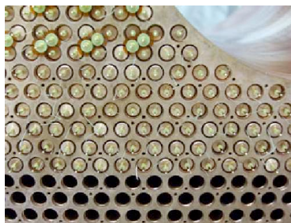
(a) Matrice d'un module du FCAL pendant l'assemblage. .
