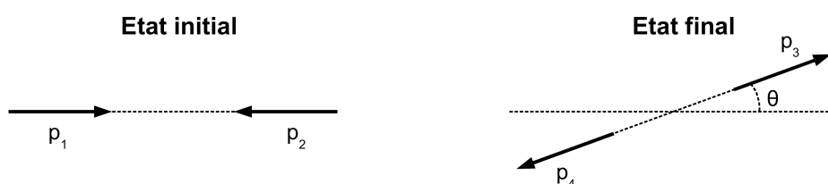
FIGURE 2.1: La diffusion élastique ne fait intervenir que l'angle \theta dans le référentiel du centre de masse. Le plan de diffusion est aléatoire.
