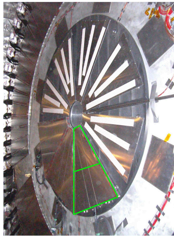
FIGURE 1.24: Photo de la face avant d'un des end-cap du détecteur ATLAS sur lequel sont installés les différents secteurs du MBTS (souligné de vert). Chaque secteur du MBTS couvre 45^\circ de la surface du end-cap et se divise en deux segments couvrant 2.1 < |\eta| < 2.8 et 2.1 < |\eta| < 3.8 .
