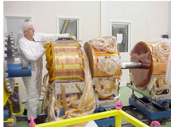
(b) Les différents modules du FCal en cours d'assemblage.
