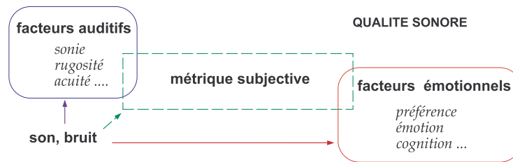
FIG. 4.2 – La qualité sonore subjective en fonction des facteurs auditifs et des facteurs émotionnels
