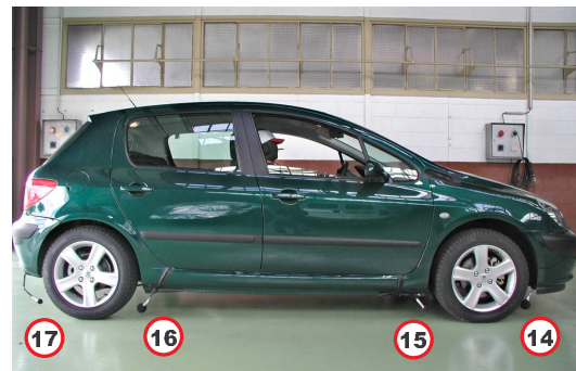
Fig. B.8 – Position des microphones sur les roues avant et arrière droites
