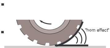
Fig. 3.8 – Le mécanisme de "horn effect"
