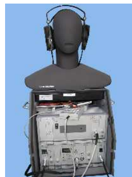
Fig. B.3 – Casque microphonique (en haut) et tête acoustique (en bas)
