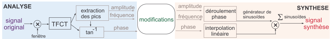
FIG. 9.4 – Schéma d'analyse-synthèse du modèle sinusoïdal
