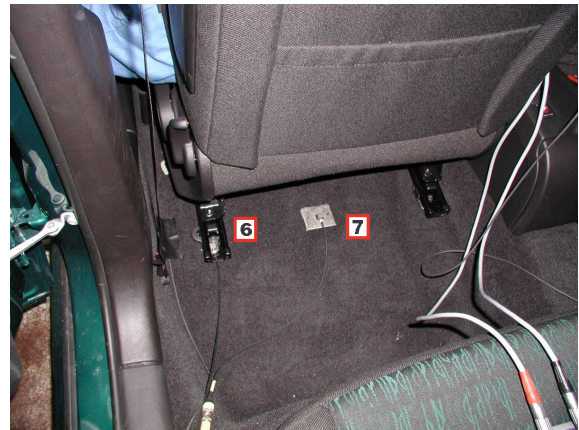
Fig. B.11 – Accéléromètres dans l'habitacle sur la glissière du siège conducteur et le plancher. Vue d'ensemble (en bas), zoom sur les capteurs (en haut)
