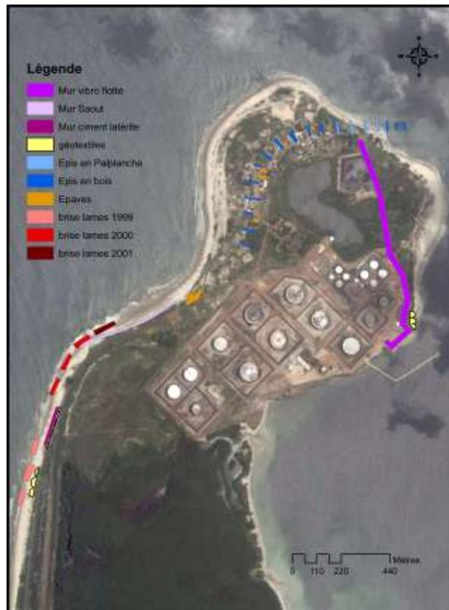
Figure 107 : Ouvrages de protection côtière au Cap Lopez
