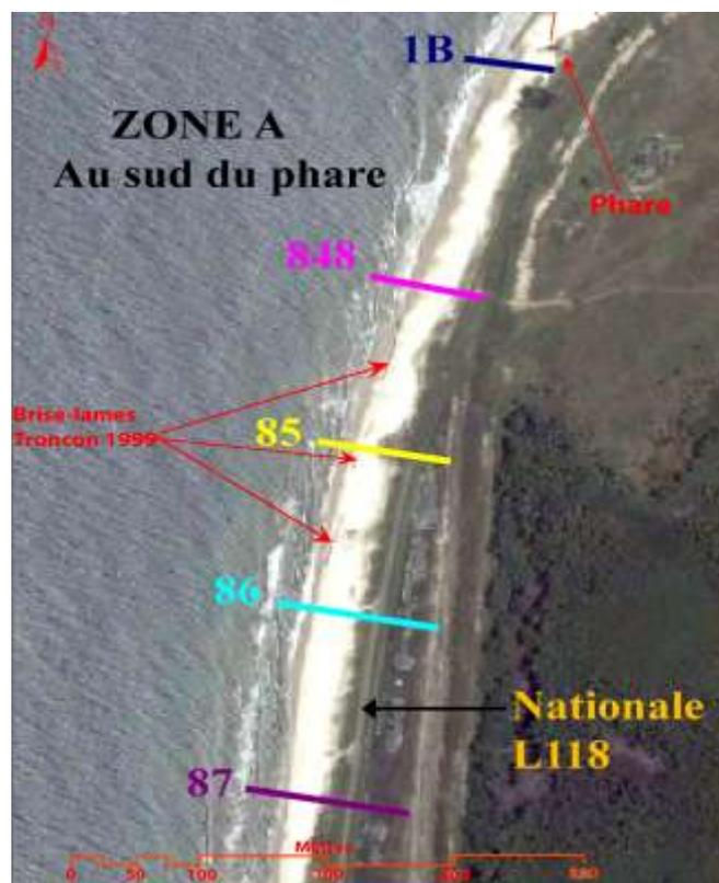
Figure 56 : Profils de suivi de la courbe +2m : zone A
