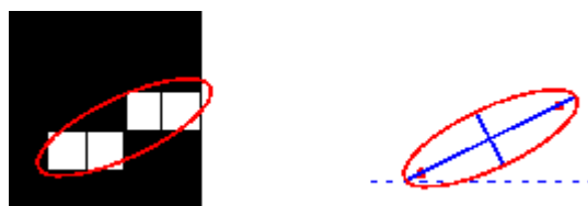
Figure II.64 : Détermination de l'orientation de l'objet sous Matlab (angle entre l'axe horizontal représenté en pointillé et l'axe principal)
