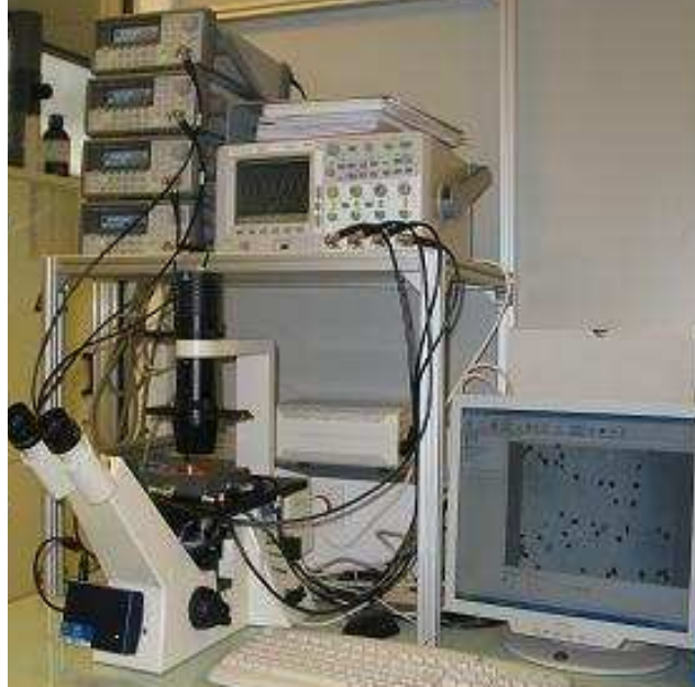
Figure II.51 : Dispositif expérimental (en haut : côté électrique, en bas, partie microsysteme et optique : pilotage des appareils et acquisition sur PC via les interfaces GPIB et Firewire)
