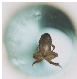
Figure I.15 : Grenouille en lévitation au-dessus d'une bobine qui produit un champ magnétique de 16T [53]
