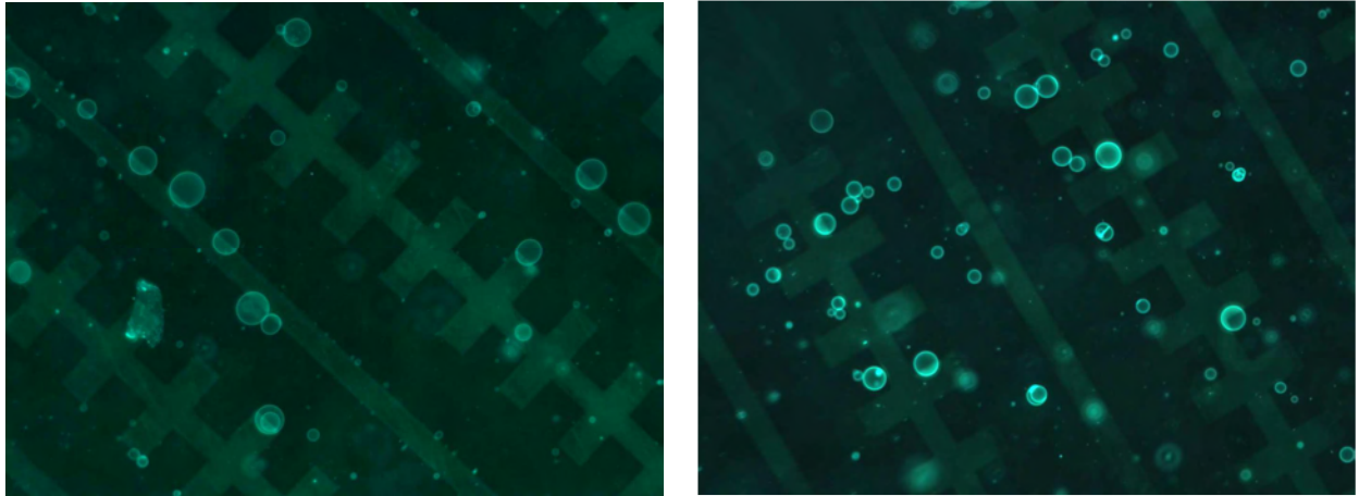
Figure IV.94 : à gauche, les liposomes électroformés sont soumis à la diélectrophorèse positive ; à droite, ils sont soumis à la diélectrophorèse négative
