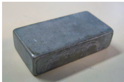
Figure IV.97 : Aimant permanent rectangulaire en Neodyme-Fer-Bore (dimension 2 \times 4 cm )
