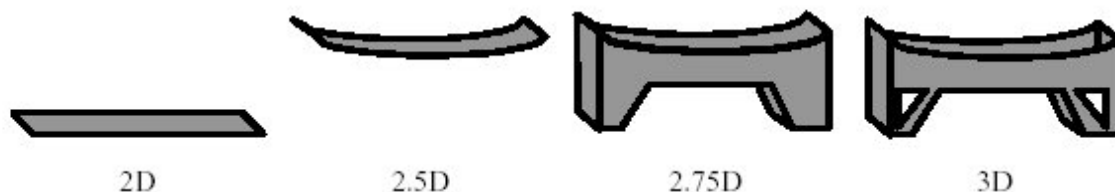
Figure 2 : Exemple de représentation d'un pont selon les différents types de modèles disponibles (2D, 2.5D, 2.75D et 3D, source : [Devogele, 1997])
