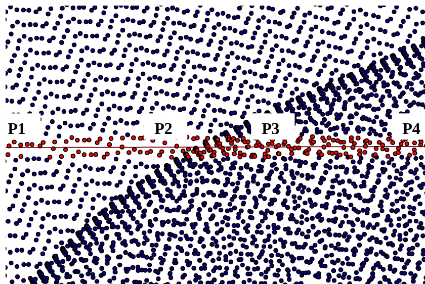
Figure 75 : Visualisation des points Lidar total et ceux situés à 2m du trait de coupe de l'étude.
