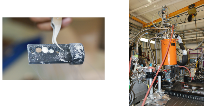
FIGURE 12.18 Photos du porte-échantillon après congélation (à gauche) et de la ligne expérimentale pénétrant dans le cryostat -cylindre orange- (à droite).
