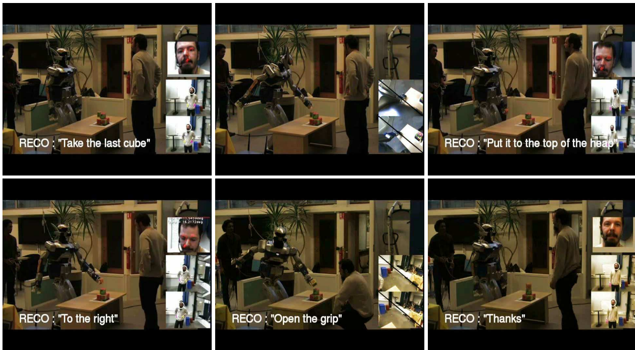
FIG. IV.9: Une réalisation du scénario de jeu (n°3) avec fusion des données vocales et gestuelles : vue d'ensemble -image principale-, résultats des modules GEST et GAZE -images incrustées-, la reconnaissance et l'interprétation de la parole sont assurées par le module RECO .
