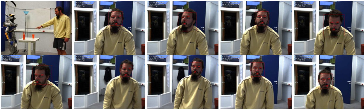
FIG. II.9: Exemple de réalisation : situation H/R (haut gauche) et suivi sur une séquence acquise depuis le robot. Les croix rouges représentent les centroïdes estimés des régions d'intérêt.
