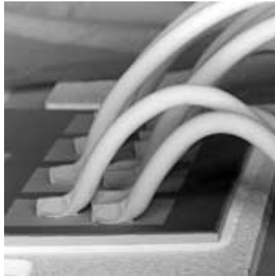
a) Fils de bonding réels
