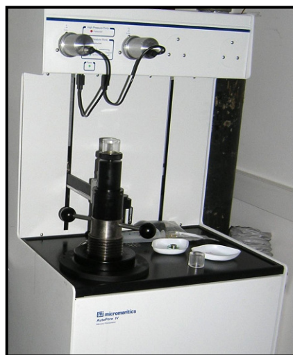
Figure 2.26 : Porosimètre Micromeritics® AutoPore IV 9500
