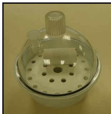
Figure 2.32 : Echantillon sous cloche à humidité relative contrôlée
