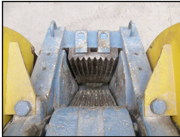
Figure 4.3 : Photographie du concasseur utilisé et vue en hauteur des mâchoires
