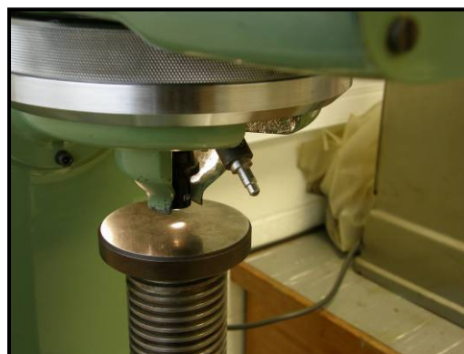
Figure 3.20 : Photographie du dispositif expérimental d'essai Brinell
