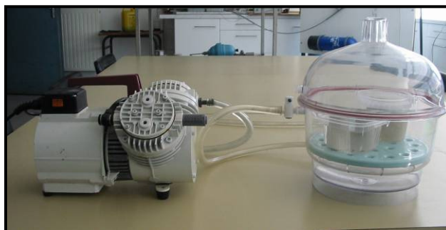
Figure 2.25 : Dispositif de mesure de porosité à l'éthanol sous vide (à gauche : pompe à vide ; à droite : cloche contenant les échantillons baignant dans l'éthanol).
