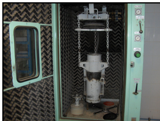
Figure 4.33 : Schéma et photographie de l'appareil de confection par vibro-compression des mélanges traités au LHR
