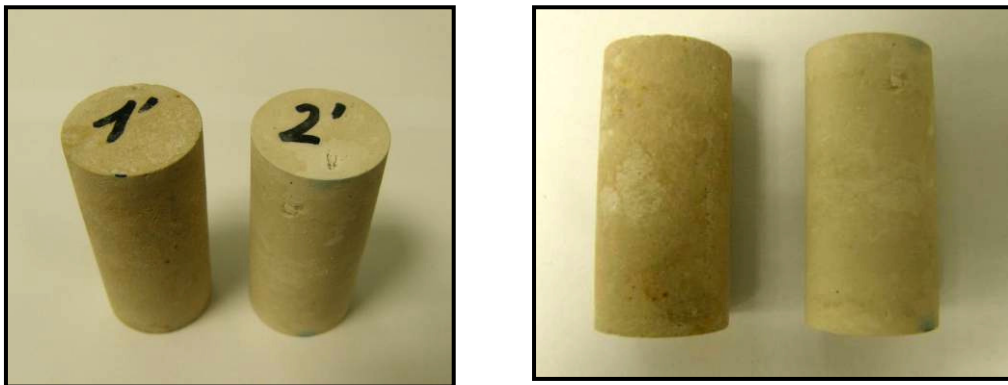
Figure 3.25 : Echantillons en sortie d'étuve à l'issue du procédé de saturation 2 (on remarque de légères traces blanches sur la surface des échantillons)
