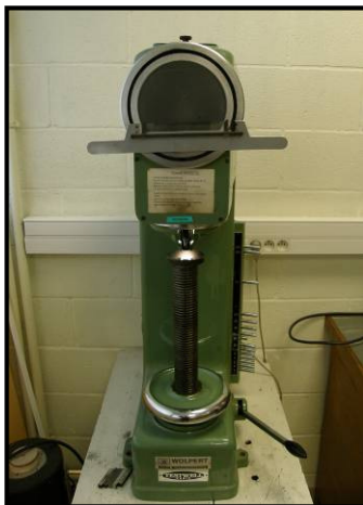
Figure 3.20 : Photographie du dispositif expérimental d'essai Brinell
