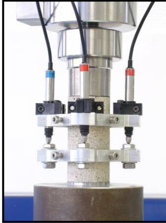
Figure 2.18 : Echantillon de mortier instrumenté à l'aide des colliers de LVDT [AGOSTINI]
