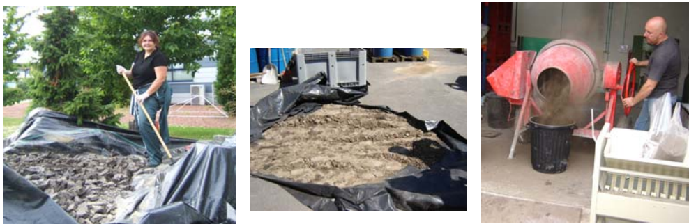
Figure II-2 : Homogénéisation du sédiment
