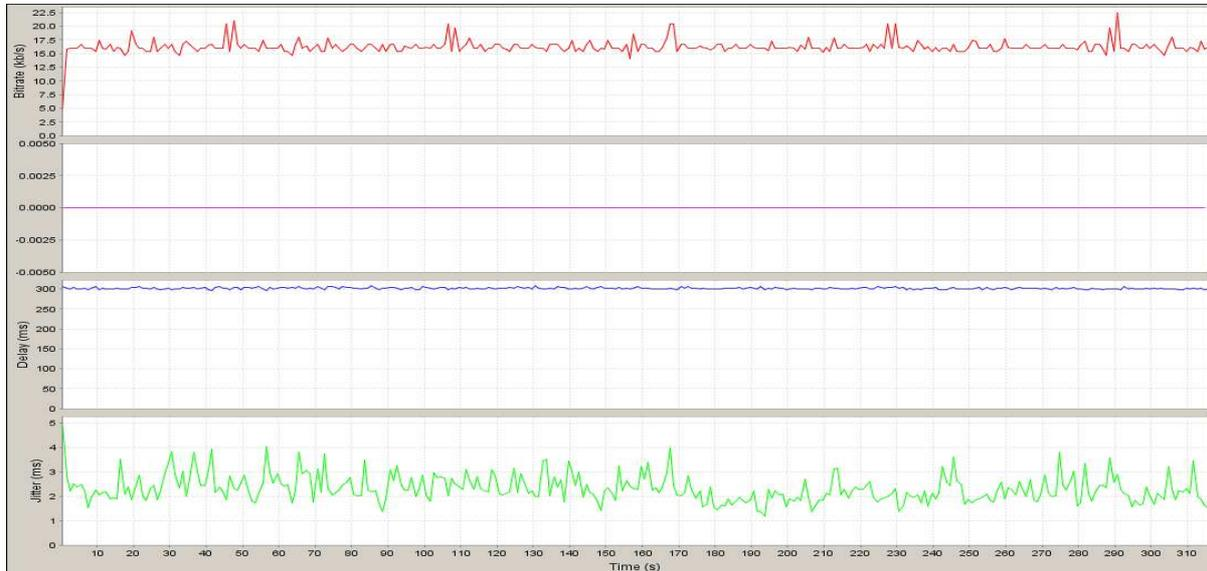
Figure V.23 Débit IP, délai, pertes de paquets et gigue pour les communications VoIP
