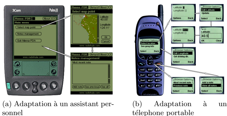
Figure II.11 – Adaptations et exemples de dialogues pour un même système par la sélection de modèles de plate-forme, de tâche et de présentation appropriés (Eisenstein et al. , 2000)
