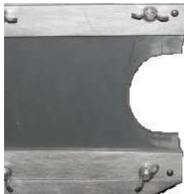
FIG. 3.9: Fissure dans une éprouvette sollicitée en glissement pur (photo Trelleborg). Les lèvres de la fissure s'écartent fortement et la pointe de fissure s'émousse.
