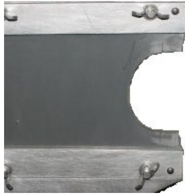
FIGURE 3.9 – Fissure dans une éprouvette sollicitée en glissement pur (photo Trelleborg). Les lèvres de la fissure s'écartent fortement et la pointe de fissure s'émousse.
