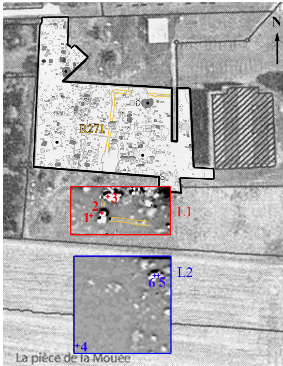
FIGURE 4.100 – Localisation des sondages effectués à la tarière, puis étudiés en laboratoire, sur les cartes du gradient magnétique vertical obtenues pour les parcelles L1 et L2. Le fossé R271 et sa continuité dans la parcelle L1 sont soulignés en orange.
