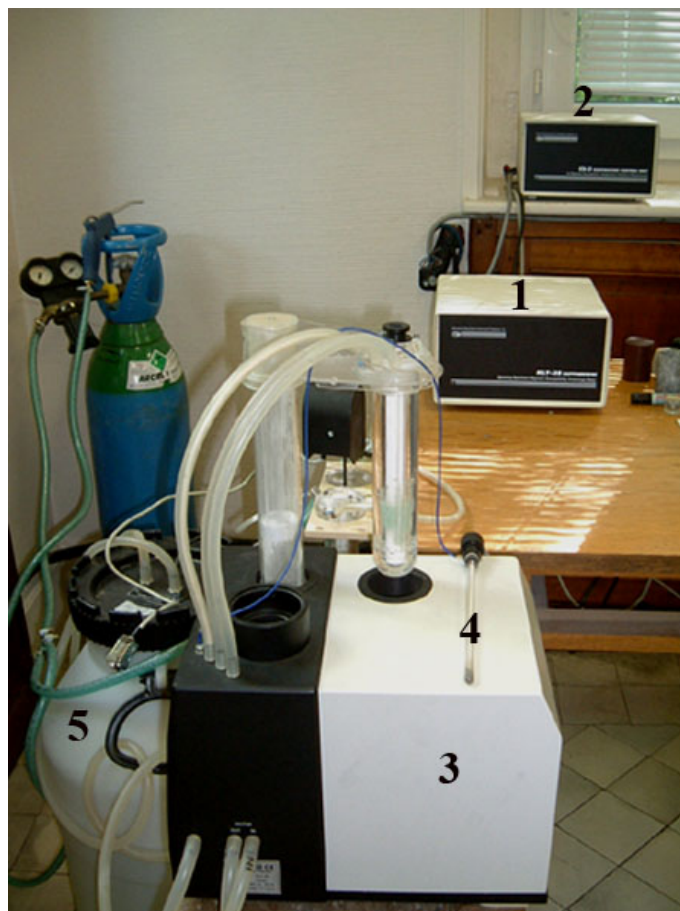
FIGURE 3.3 – Dispositif expérimental d'analyse thermomagnétique Kappabridge (Agico). 1 : susceptibilimètre KLY-3S; 2 : four CS-3; 3 : caisson contenant une bobine; 4 : tube en quartz au fond duquel l'échantillon en poudre est placé ainsi que le thermomètre; 5 : bidon d'eau.
