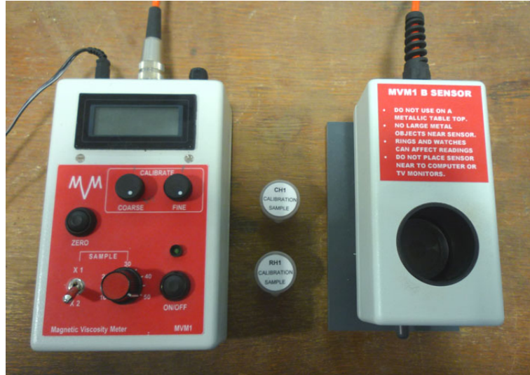
FIGURE 3.2 – Photographie de l'unité d'acquisition MVM1 (Magnetic Viscosity Meter) (à gauche), couplée au capteur MVM1B (à droite), développés par la société Pulsepower Developments Ltd. Sur la photographie sont aussi visibles les deux échantillons de sols servant à la calibration de l'appareil et fournis avec ce dernier.
