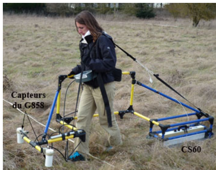
FIGURE 4.86 – Magnétomètre et CS60 couplés pour des mesures simultanées (cliché : F.X. Simon).
