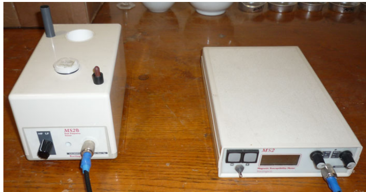
FIGURE 3.1 – Photographie du capteur MS2B (à gauche) couplé à l'unité d'acquisition MS2 (à droite) développés par la société Bartington Ltd.
