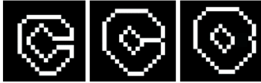
FIGURE 4.19 – Représentation de la frontière d’un objet (à gauche), de la frontière de son dilaté par un voisinage V_4 suivant notre méthode (au centre) et de la frontière du dilaté souhaité (à droite).
