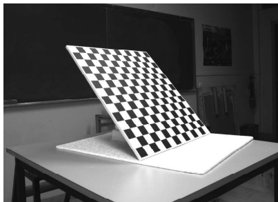
Figure 4-4 : Damier utilisé comme objet de référence pour la calibration de la caméra équipée de son objectif.
