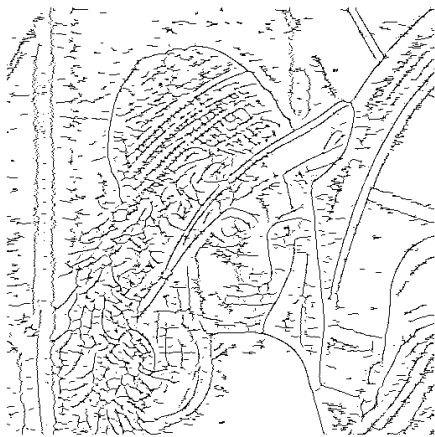
Figure 5-24 : a - Image test « Léna » de taille 512x512 en niveaux de gris codés sur 8 bits ; b - Résultat de la détection de contours obtenu avec le filtre proposé ( \alpha = 1 , \omega = 0.01 , m = 1 , d = 0.01 ) ; c – Résultat de la détection de contours obtenu avec le filtre de Deriche ( \alpha = 1 ).
