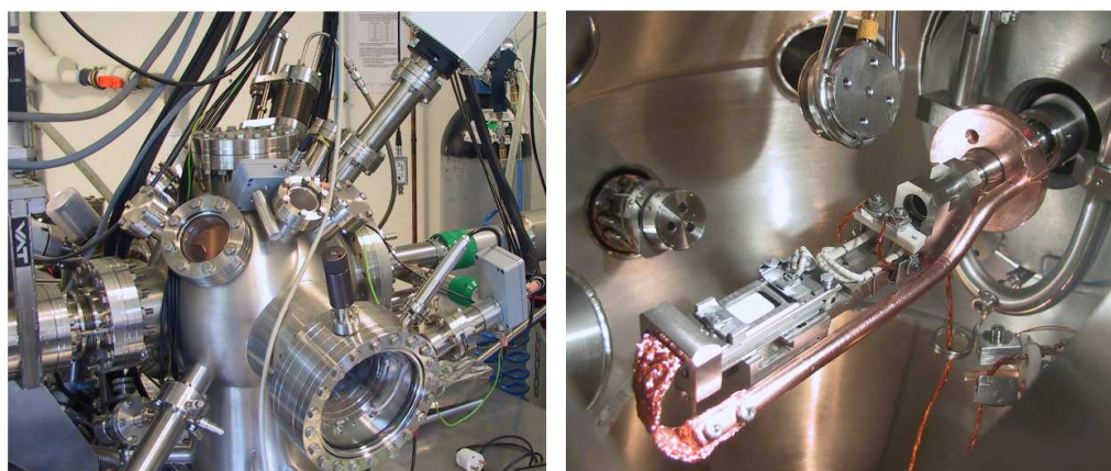
FIGURE 4.2 – Vues extérieure et intérieure de la chambre de préparation. Le système LEED-Auger, le canon à ions et le spectromètre de masse sont visibles sur la vue extérieure tandis que la vue intérieure montre le bloc à température variable, le triple évaporateur ainsi que la balance à quartz.
