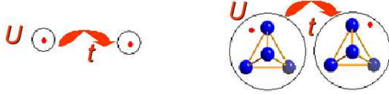
FIGURE 2.7 – Représentation schématique d’un isolant de Mott classique, où la répulsion coulombienne a lieu sur un site atomique, et d’un isolant de Mott ‘à cluster’ où la répulsion coulombienne a lieu sur un site moléculaire. [43] [53]
