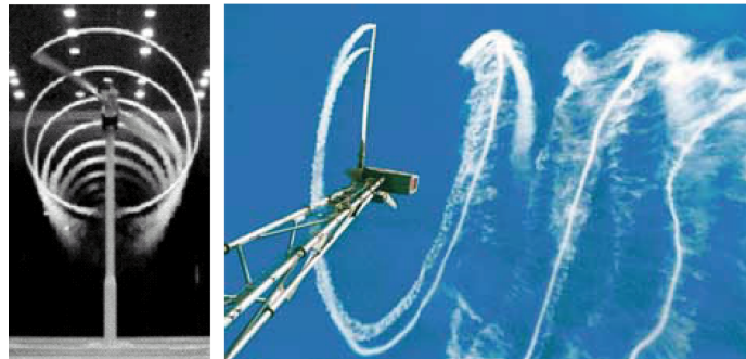
FIG. 3.4 – Visualisation de lâchés de fumée dans le sillage d'une éolienne bipale. Image de gauche : régime stable, faible turbulence (non précisée) ; Image de droite : régime instable. (données RISØ, Danemark).
