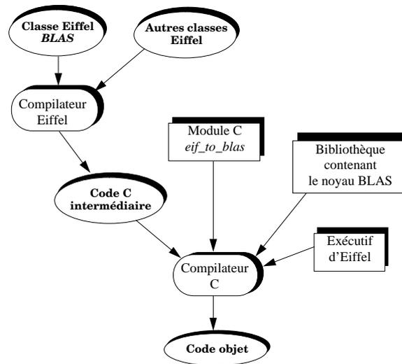
FIG. 4.10 - Interfaçage d'Eiffel avec le noyau BLAS
