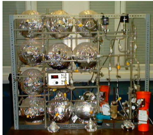
Figure 2.2 : Photographie du bâti de préparation des mélanges gazeux.
