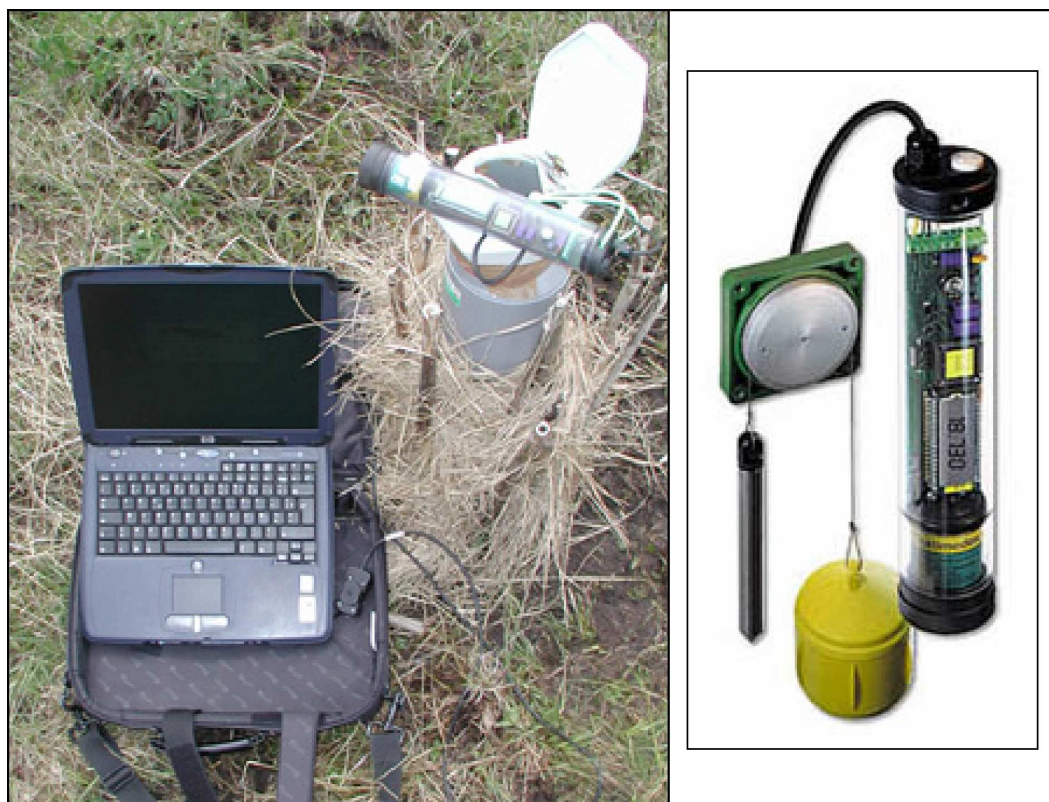
Photographie 12 : Relevé d'un codeur limnimétrique de type OTT-Thalimedes sur Ribains
