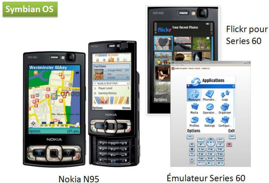
Figure 124 - Le système d'exploitation Symbian OS s'exécutant sur le dispositif N95 et sur l'émulateur du SDK Series 60.
