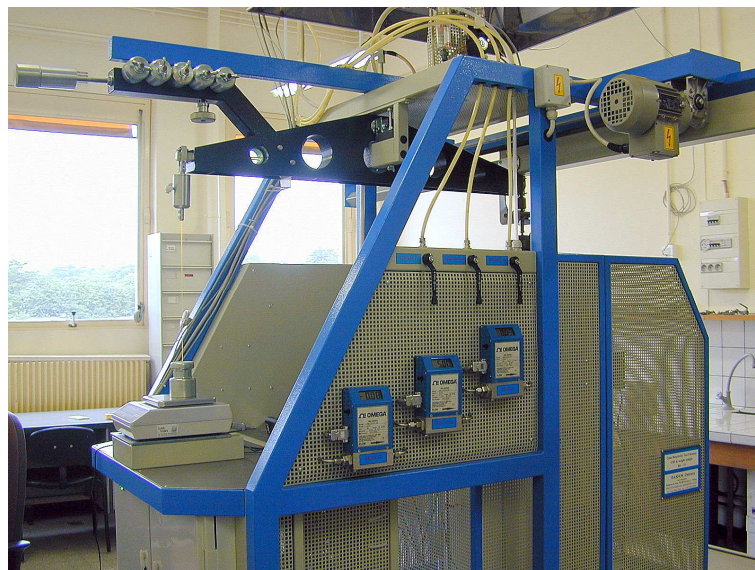
Figure 3.3. Photo de l'appareillage expérimentale utilisé pour étudier la cinétique de gazéification d'un lit de coke : (a) réacteur, (b) balance.
