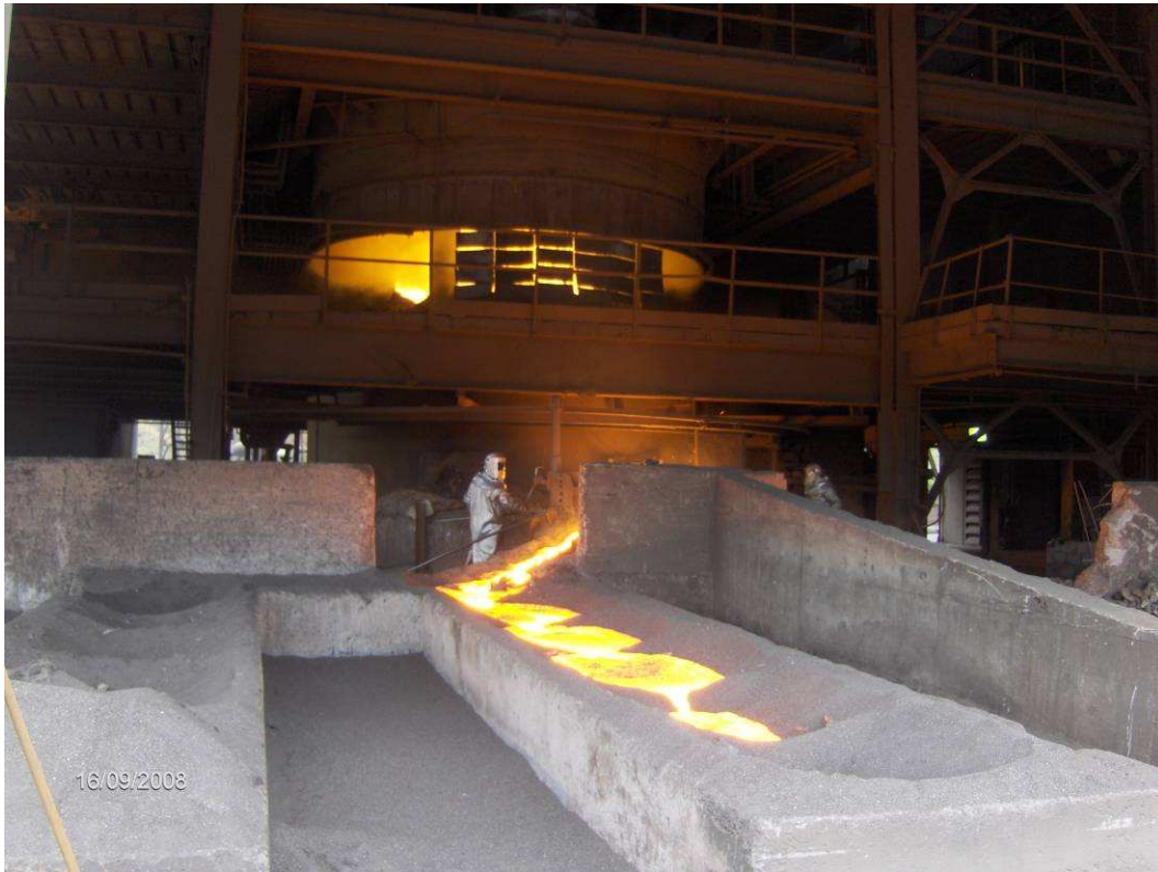
Figure 1.1. La coulée de ferrosilicomanganèse chez Vale à Ouro Preto, Brésil.
