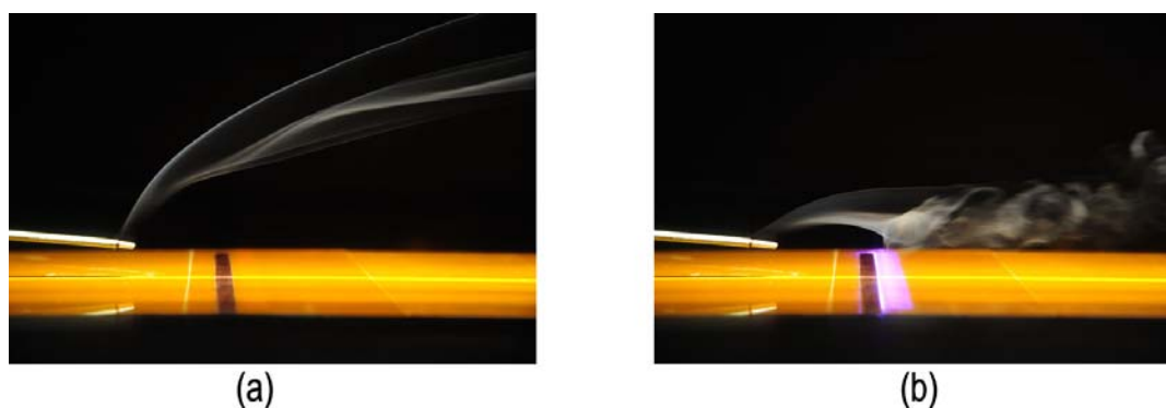
Figure 2.13 – Visualisation du vent ionique par fumée d'encens : (a) actionneur éteint et (b) actionneur allumé ( V_{HV} = 10 \text{ kV} , f_{HV} = 1 \text{ kHz} )
