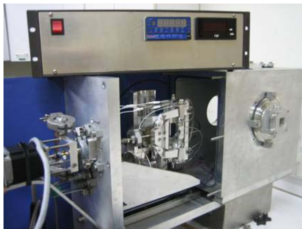
Fig. 0.5. TSAXS dans l'enceinte sous vide et module de contrôle TSAXS
