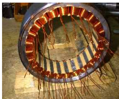
Fig. 1.5 : Bobinage concentré pour machine à flux radial [Leroy Somer]
