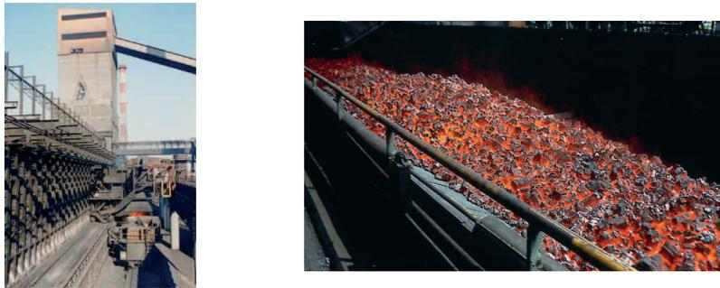
FIGURE 1.4 – Défournement et coke défourné.
