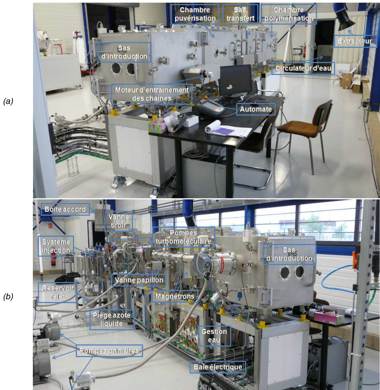
Figure 62 : (a) Façade avant et (b) façade arrière de P3.
