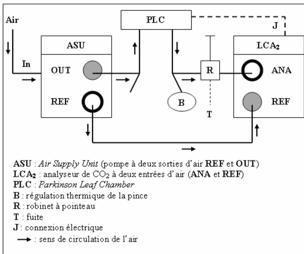
**Figure 2.6** – Description du système ADC LCA<sub>2</sub> (modifié de REPELLIN, 1994)
