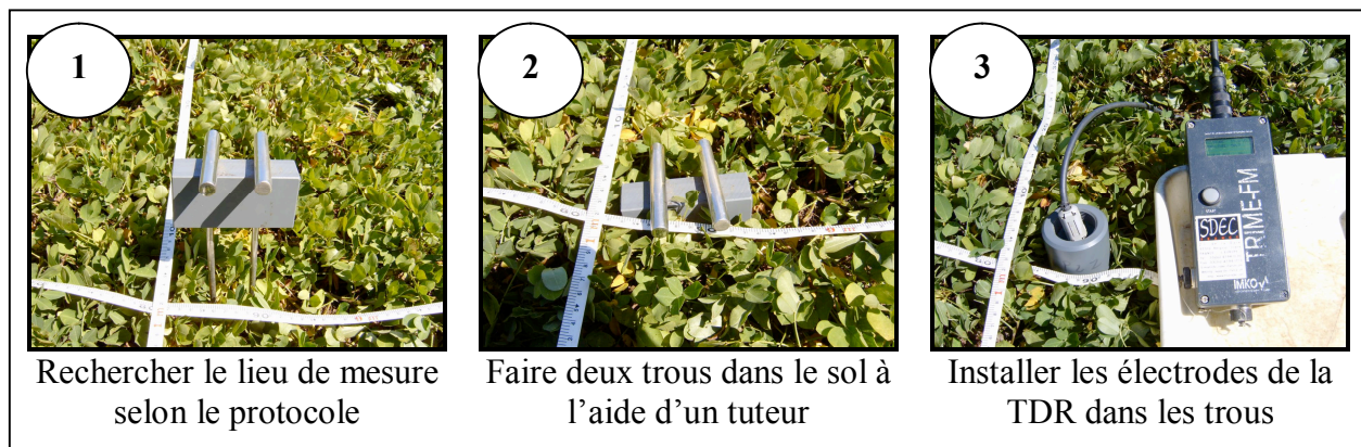
Figure 2.10 – Description de la mesure d'humidité du sol par TDR
