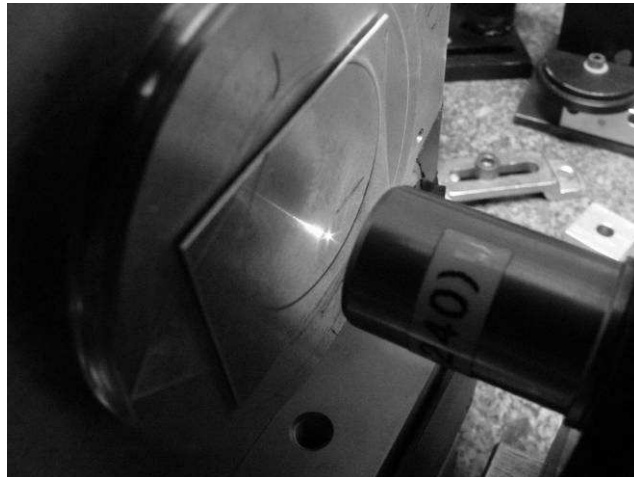
Figure 4-2. Photographie du dispositif de micro-usinage. Le faisceau est focalisé 1mm avant la cible pour visualiser le plasma dans l'air (la cadence de répétition est de 10 kHz).
