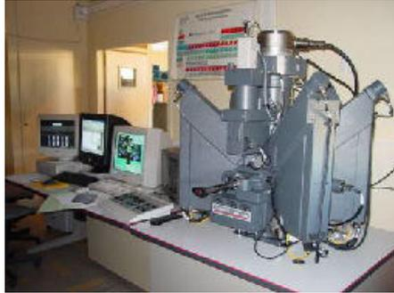
Figure II.17: Microsonde Cameca SX100
