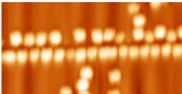
Figure I-52 : Image AFM des îlots de Ge positionnés sur une ligne de dislocations.
