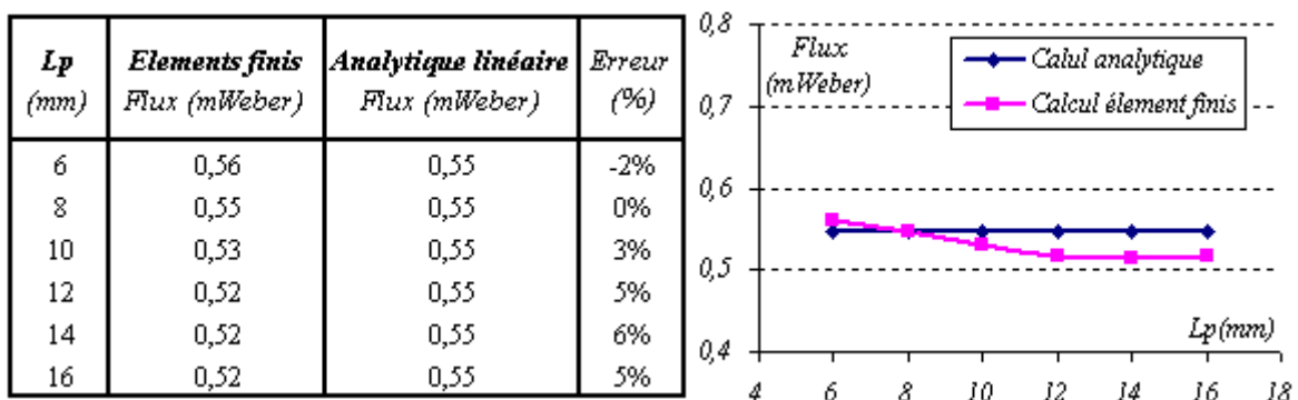
Fig. 3.38 : Comparaison du flux de l'aimant calculé par les deux modèles
